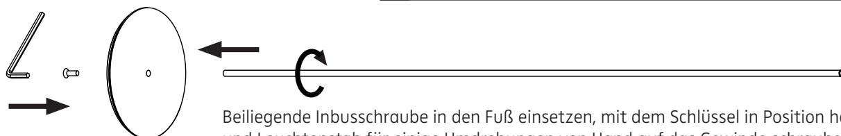
Beiliegende Inbusschraube in den Fuß einsetzen, mit dem Schlüssel in Position halten und Leuchtenstab für einige Umdrehungen von Hand auf das Gewinde schrauben.
