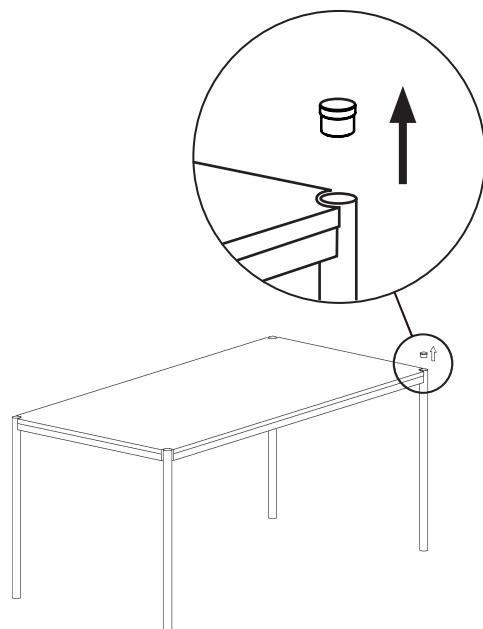
Verschraubungen kontrollieren / festziehen !
