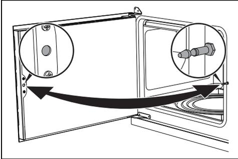
Die Türen der Multifunktionsöfen öffnen sich seitlich oder nach unten geklappt. Zum Öffnen den Türgriff zu sich hinziehen. Zum Schließen die Tür zudrücken, bis ein mechanisches Einklicken zu hören ist.
