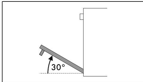
3. Zum Wiedereinsetzen der Tür müssen die Scharniere in die dafür vorgesehenen Schlitz am Backofen eingefügt werden, wobei sichergestellt werden muss, dass die Aussparungen **A** fest auf den Schlitz aufliegen.
