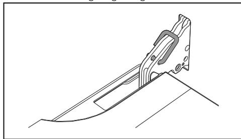
2. Die Tür an beiden Seiten und mit beiden Händen festhalten, in einem Winkel von etwa 30° anheben und herausziehen.
