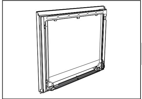
4. Die Innenverglasung nach erfolgter Reinigung wieder in die Bügel einsetzen. Darauf achten, die 4 Zapfen zu zentrieren und mithilfe der Leisten an der rechten und linken Seite, die ein optimales Einrasten gewährleisten, in ihre Aufnahmen an der Tür einsetzen.
