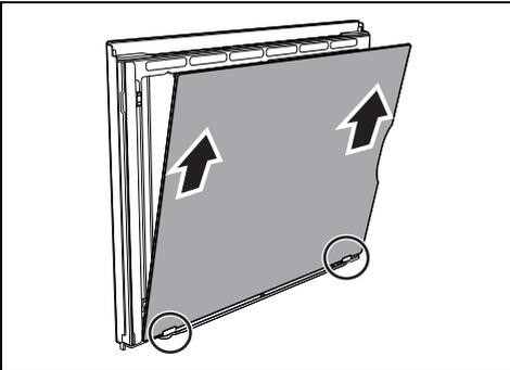
3. Nach Entfernen der Innenverglasung kann auf die Tropfenauffangleiste zugegriffen werden.
